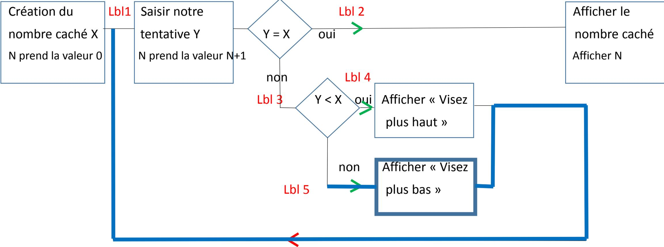
$\text{Int}(1000 \times \text{RAN}\#) \rightarrow X : 0 \rightarrow N : \text{Lbl1} : ? \rightarrow Y : N+1 \rightarrow N : \text{If } Y=X : \text{Then Goto2} : \text{Else Goto3} : \text{Lbl3} : \text{If } Y < X : \text{Then Goto4} : \text{Else Goto5} : \text{Lbl4} : \text{«+»} : \text{Goto1} : \text{Lbl5} : \text{«-»} : \text{Goto1} :$
